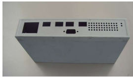
箱物 レーザー/パーリングタッブ/曲加工 リベット/溶接/カチオン塗装/焼付塗装
