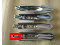
プレス部品 プレスによる絞り加工
